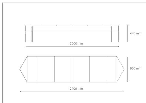
Seduta in pannello solare monocristallino colore Nero e Plex antigraffio di protezione del pannello solare.
